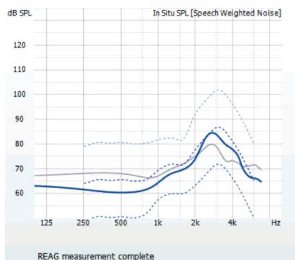
Rys. 3: Porównanie dopasowania aparatu z zastosowaniem REMfit™ (niebieski) oraz bez REMfit™ (szary).
